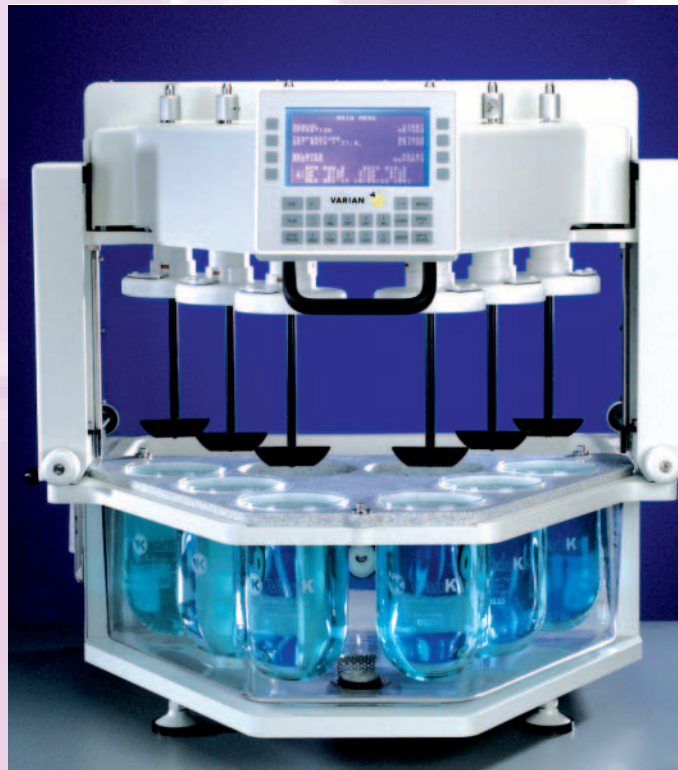
Typischer Freisetzungstester für den In-vitro-Freisetzungstest von Wirkstoffen: Im Freisetzungsmedium wird das Medikament bei 37 °C aufgelöst, das Medium mit einem „Paddel“ gerührt. Die Abmessungen des Gefäßes, die Volumina, Temperatur und Rührgeschwindigkeit müssen strikt eingehalten werden (Foto: Varian)
